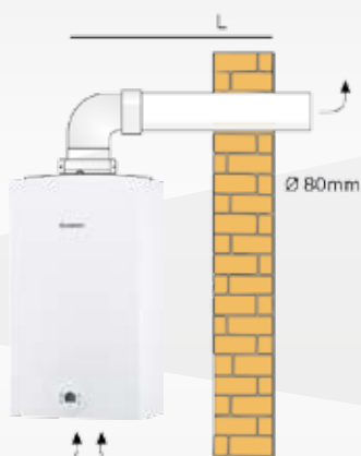
Ventilado Longitude: 0 \leq L \leq 8 m A longitude máxima depende do modelo do aparelho e da configuração do tubo de evacuação. É recomendado que se verifique os manuais de instalação.
