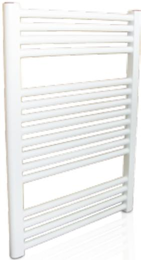
A sua fabricação em aço tubular, confere-lhe uma grande resistência e durabilidade a par de uma excelente condutividade térmica. Possibilita a ligação como equipamento opcional de resistências elétricas com ou sem termóstato. A embalagem do toalheiro contém os acessórios necessários à montagem, incluindo os suportes para fixação mural, tampões, purgador manual de ar e verniz para retoques.
